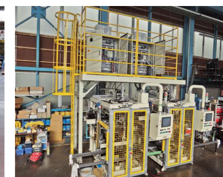
自動車用エンジンカム中心角測定装置
