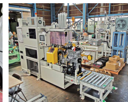
自動車エンジンモータリングテストベンチ
