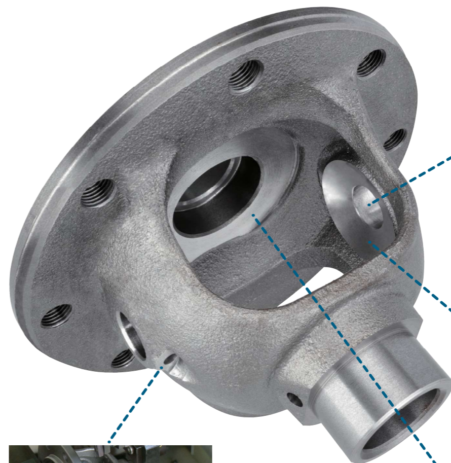
シャフト穴加工(左右) 下穴・中仕上・入口面取りの同時加工 高速リーマーにより超高速仕上げ加工
