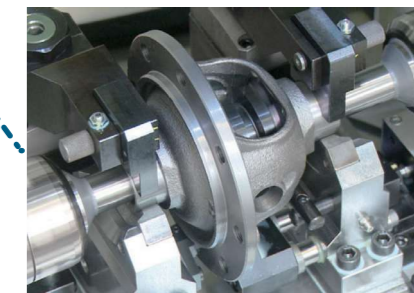
端面加工(左右) 総型カッターにより高速加工
