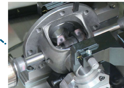
球面加工(左右) 球面と内面取りを加工
