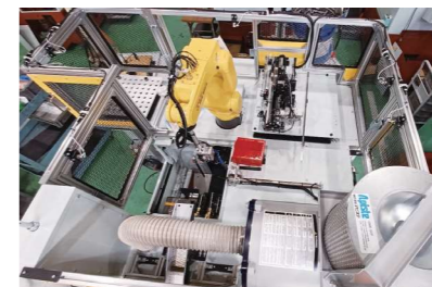
供給装置パーツフィーダ+ストレートフィーダ、パレット
