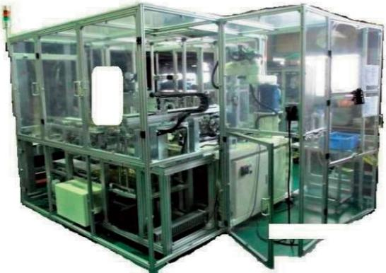
インサート成形機に関わる全ての作業を完全自動化したシステムです。（供給、インサート、取出し、組立、外観検査、寸法測定、導通検査、箱詰め等）
