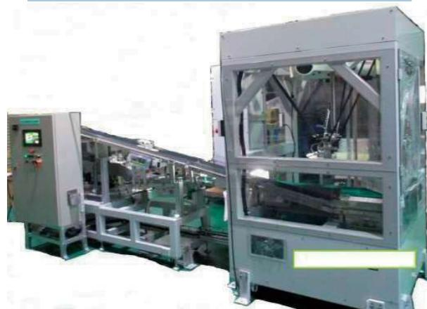
コンベア上をランダムに流れてくるワークの向き及び天地表裏を判別し、パラレルリンクロボットにて一定方向に高速で整列させます。
