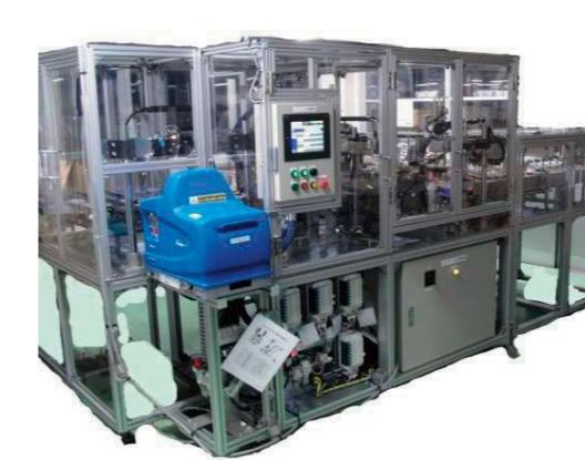
樹脂製品の組立、ブリスター、台紙のセット、ホットメルト接着剤塗布、接合までを自動化した装置です。
