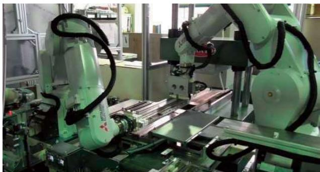
パーツフィーダーから供給された部品を整列の後、成形金型に投入、取り出した完成品に検査、組立等を行い、パレタイズ収納します。
